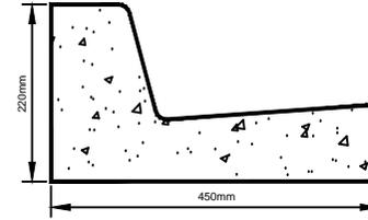
GUIA E SARJETA, EXTRUDADA - MODELO GS 450 BASE 450mm
